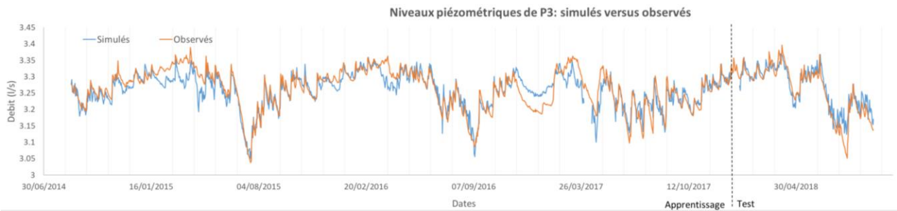
Figure 88. Niveaux piézométriques de P3 : simulés versus observés
