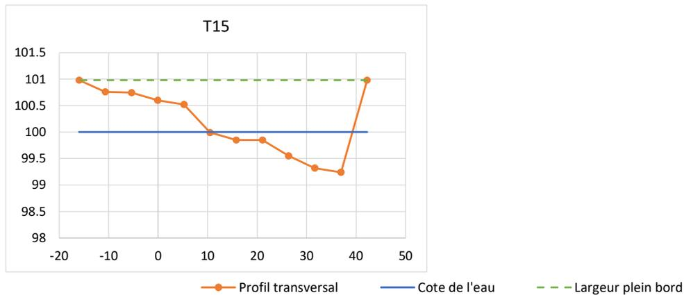
Figure 6 : Profils transversaux d'aval (T1) vers l'amont (T15) de la station de Jeurre
