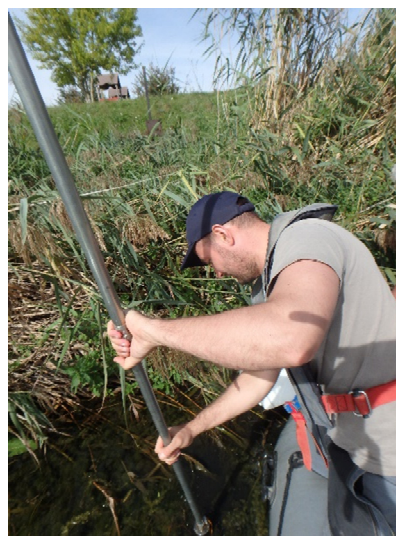
Figure 5 : Prélèvement au carottier. Gare d'eau de Saint-Jean-de-Losne (21), le 28/09/2021
