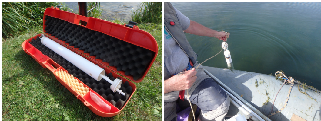
Figure 8 : Bouteille à prélèvement Kemmerer et utilisation sur la gare d'eau de Saint-Jean-de-Losne (21), le 28/09/2021.
