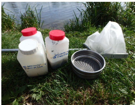
Figure 4 : filet haveneau (vide de maille 500 µm), tamis (vide de maille 500 µm) et prélèvements conditionnés, gare d'eau de Saint-Jean-de-Losne (21) le 28/09/2021.
