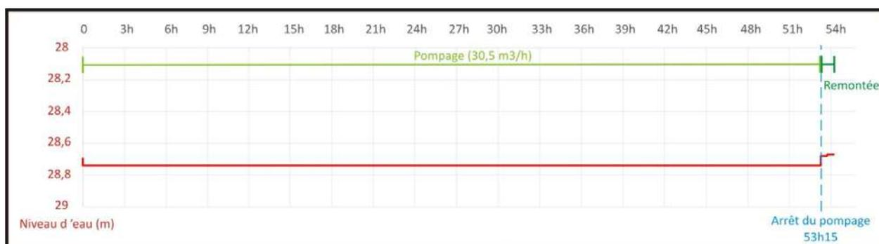
Figure 9 : Profondeur d'eau durant l'essai de pompage longue durée et la remontée.
