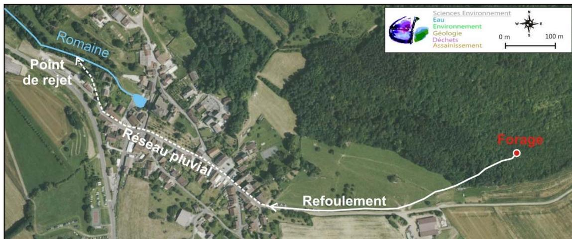
Figure 13 : Planche photographique de l'installation de pompage et de refoulement
