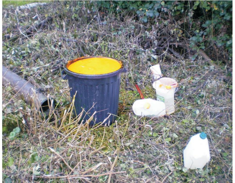
*Le colorant est préalablement dilué dans un récipient de 80 l avant d'être injecté*
