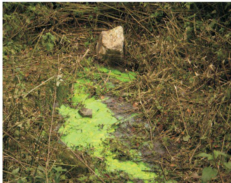
*Une fois dilué, le colorant est déversé sur la zone d'infiltration et "poussé" par 6 m<sup>3</sup> d'eau afin de favoriser sa circulation dans la roche*
