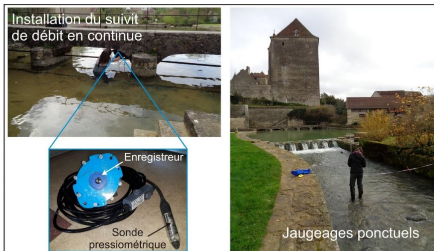
Figure 15 : Plaque photographique des installations de suivi de débit à la Romaine
