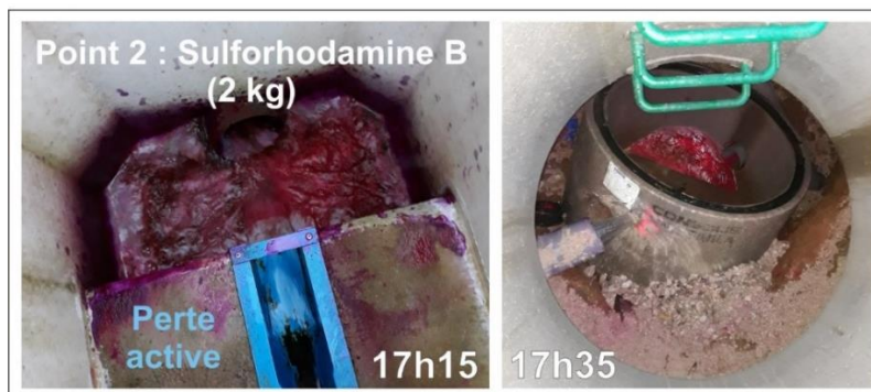
Figure 27 : Photographie de la perte active pendant l'injection de sulforhodamine B
