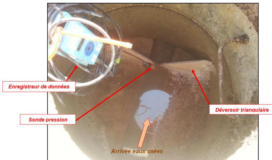
Figure 2 : Exemple de mesures de débit en réseau gravitaire via un seuil et une sonde de pression
