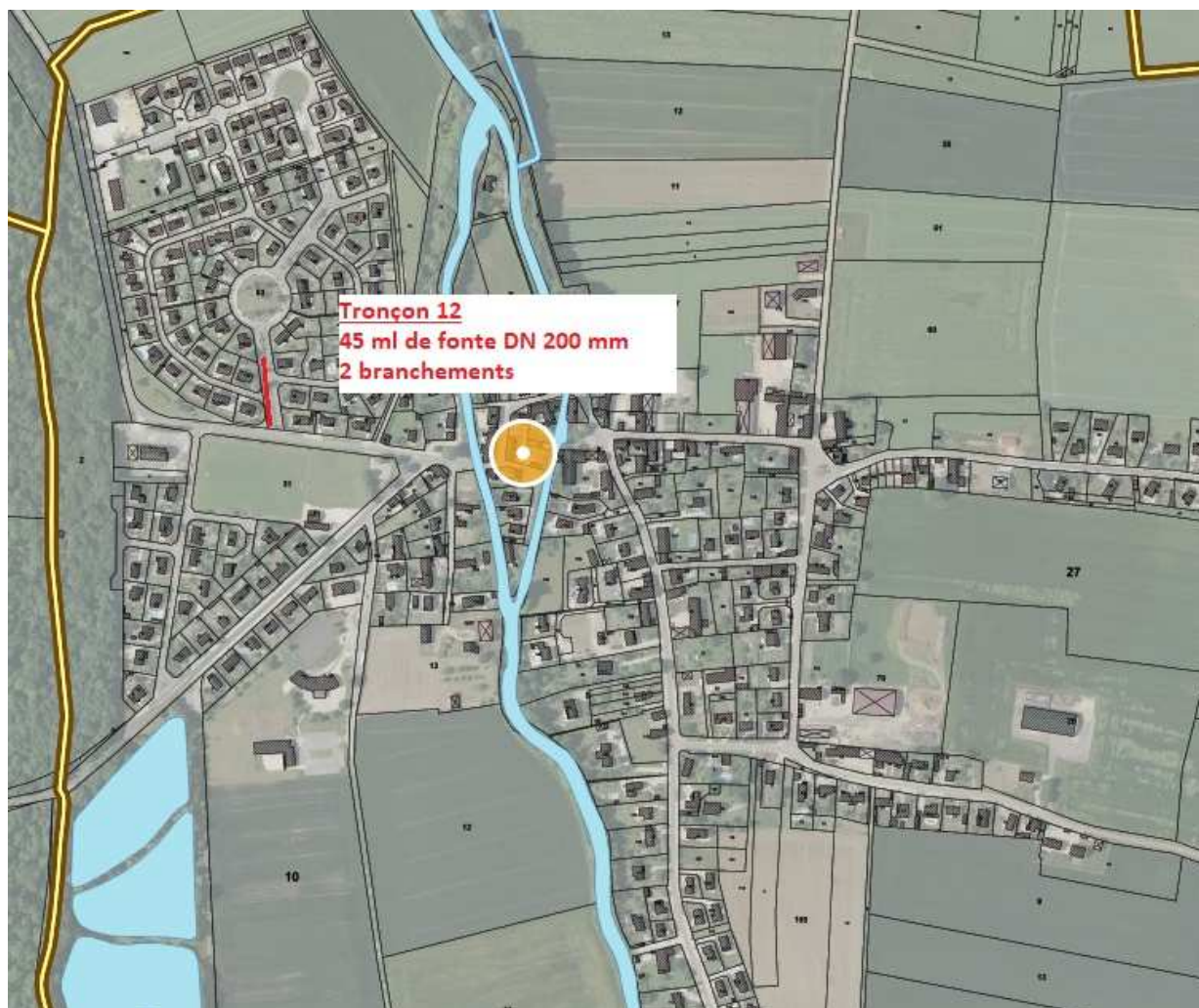
Figure 14 : Illustration travaux prévus sur Remilly-sur-Tille
