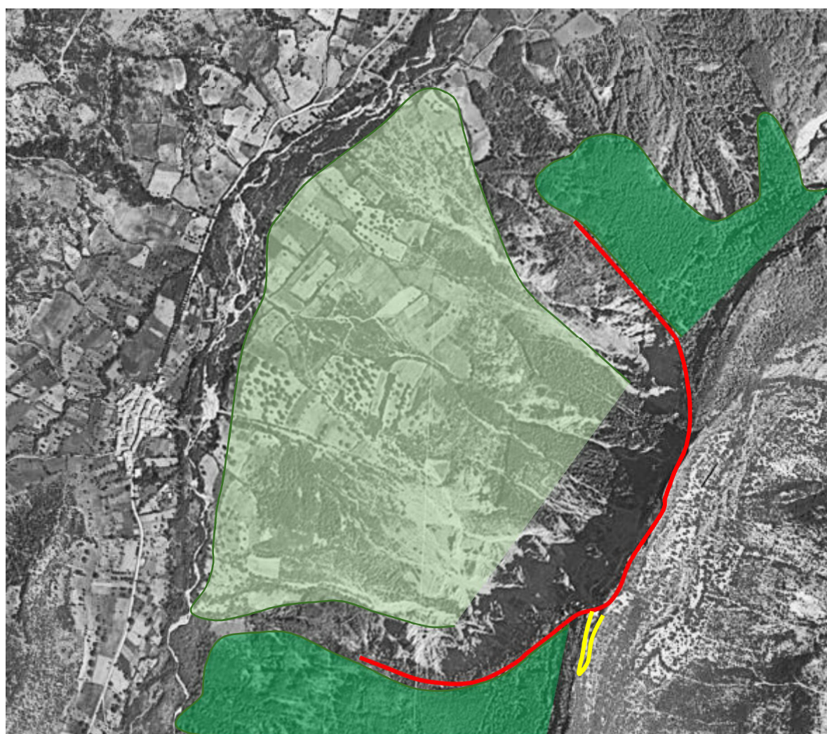
Figure 9 : Alvéole torrentielle de Clarmontard. En vert foncé les glacis anciens, non retouchés par l'érosion torrentielle. En vert clair, le glacis récent, formé par les écroulements et l'activité torrentielle. En rouge la niche d'arrachement et de recul dans les calcaires du Tithonien. En jaune la grande fissure ouverte en partie méridionale.
