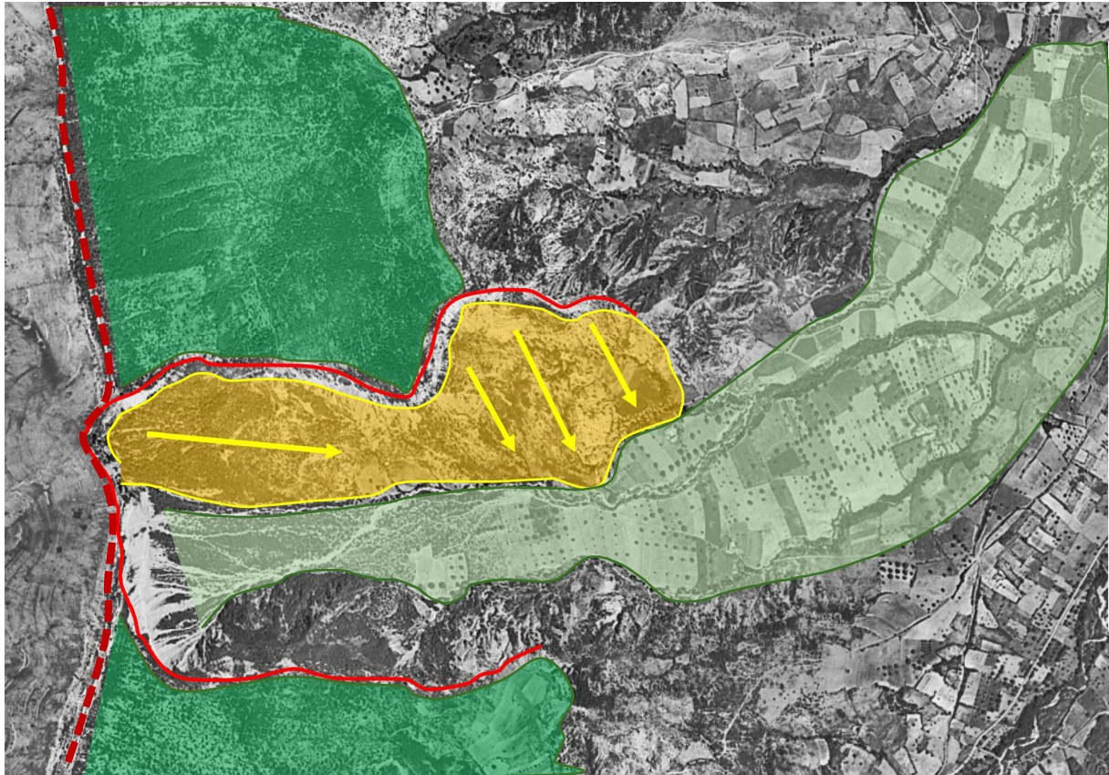
Figure 11 : Alvéole torrentielle du Rif Charrel. En vert foncé les glacis anciens, non retouchés par l'érosion torrentielle et les glissements de terrains. En orange, les grands glissements anciens pouvant encore évoluer. En rouge la niche d'arrachement (ravinement, glissement) et de recul dans les calcaires. En tirets rouges la corniche de calcaires Tithonien. En vert clair le glaci récent, composé d'éboulis et de déjections torrentielles.
