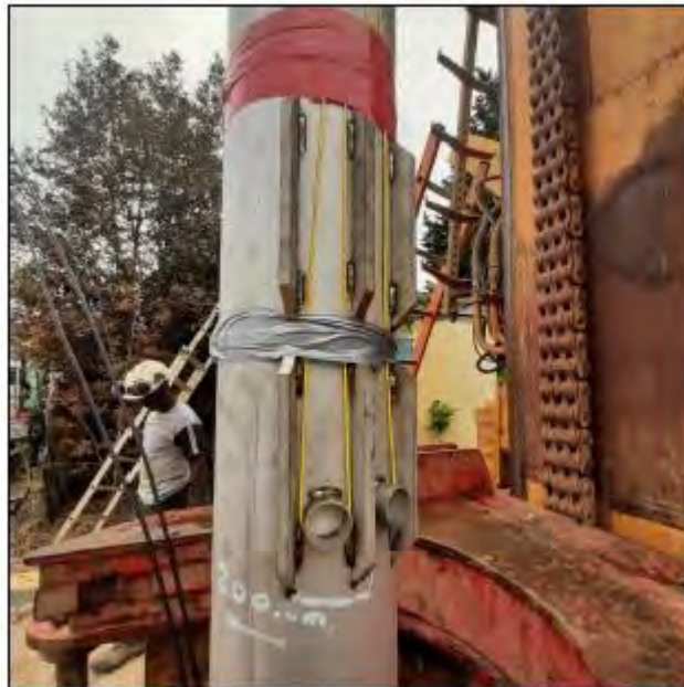
Figure A- 27 : Fibres optiques pour mesures sismiques (gaines jaunes Ø 3 mm) avec centreurs de protection
