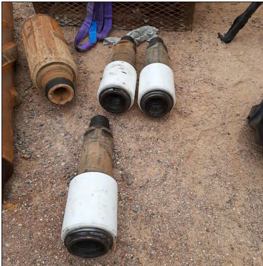
Figure A- 33 : Protecteurs de tiges en POM pour la foration à l'intérieur des tubes inox
