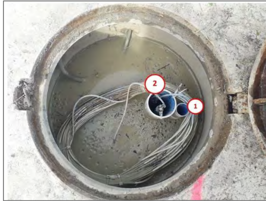
Figure 14 : Tête de forage de DEMENT1 avec l'accès aux deux piézomètres.
