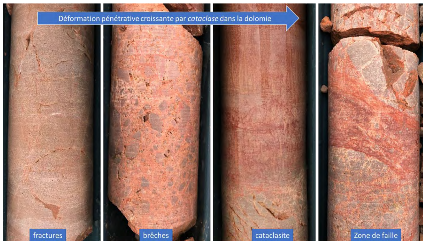
Figure 21 : Vue détaillée des déformations au sein des dolomies
