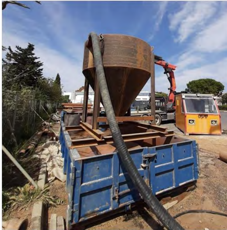
Figure A- 21 : Cyclone et bac de récupération des cuttings
