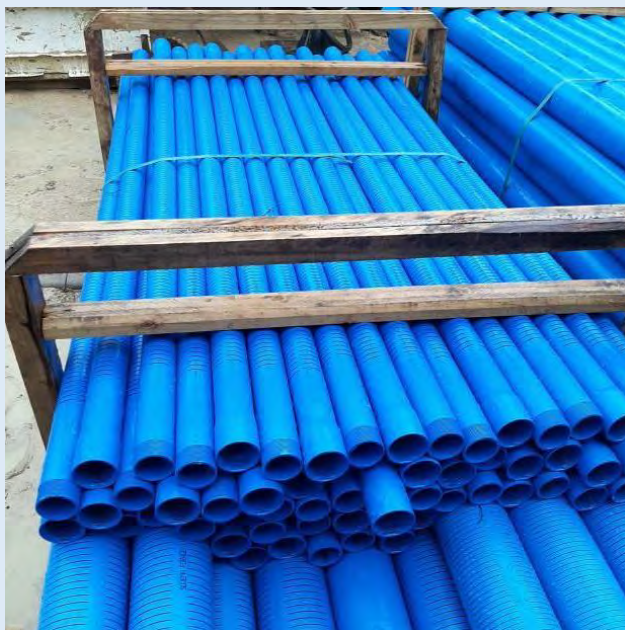
Tubages et crépines PVC Ø 52 – 60 mm et 112 – 125 mm
