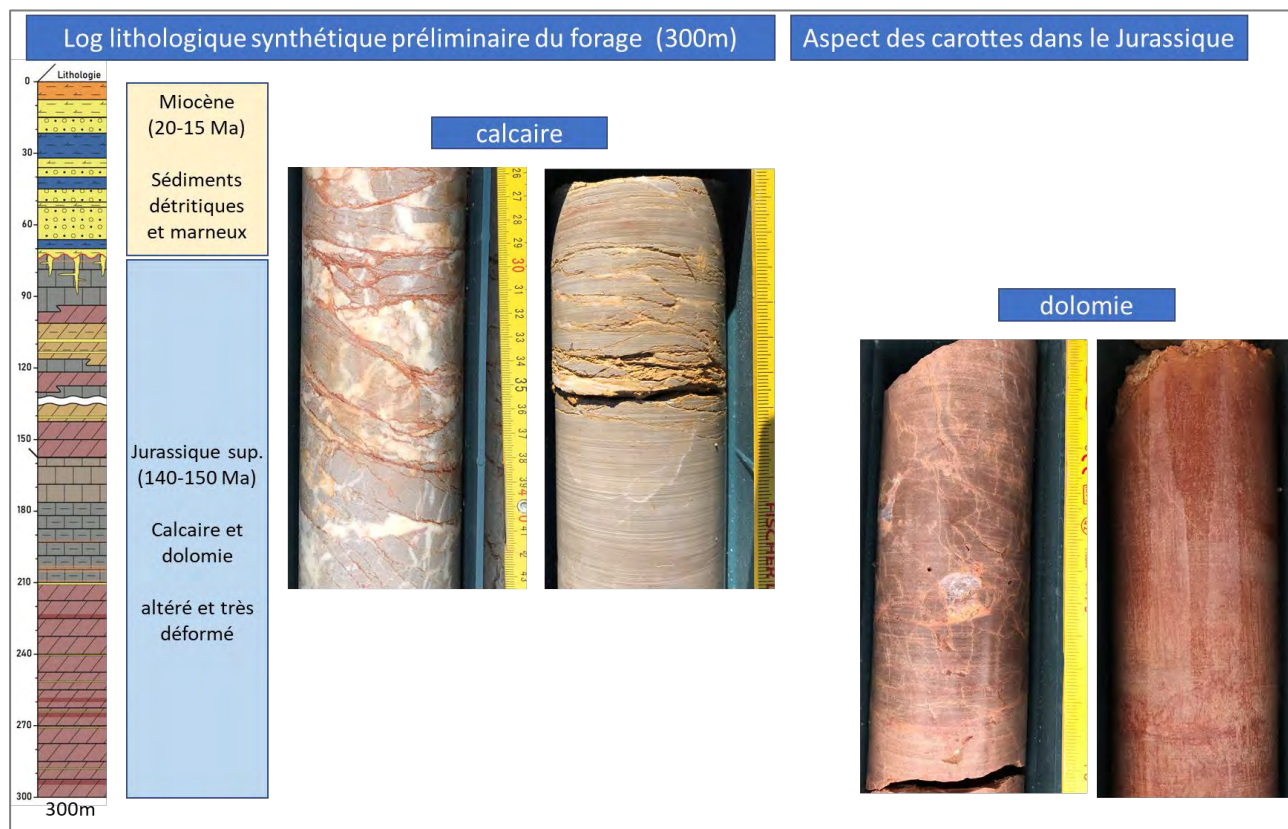
Figure 20 : Log lithologique synthétique préliminaire de l'ouvrage DemT3
