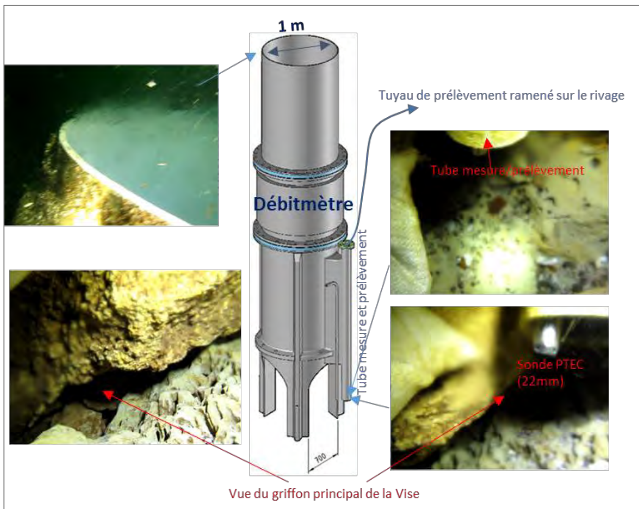
Figure 5 : Planche photographique du dispositif de mesure sous-marin de la Vise
