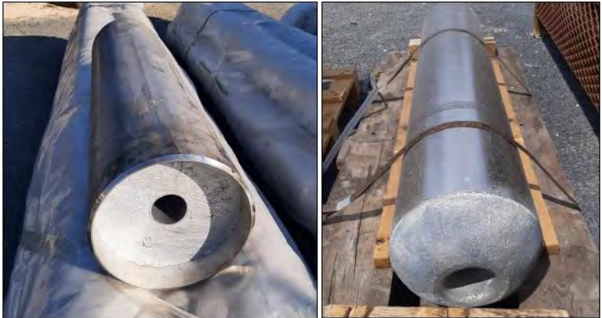
Figure A- 25 : anneau de cimentation à bille et sabot de cimentation à bille
