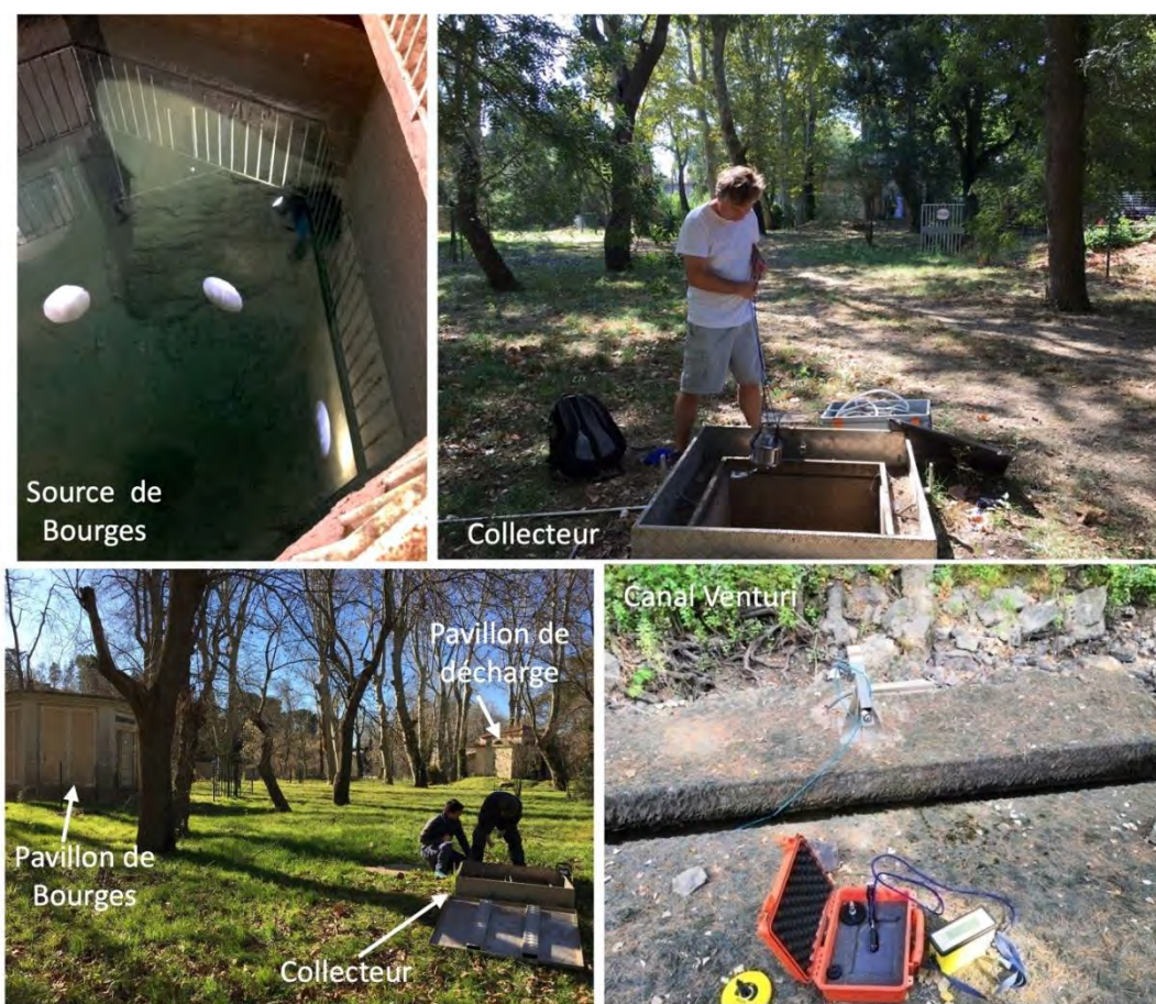
Figure 12 : Sources d'Issanka : Installation d'un fluorimètre dans le collecteur des différentes sources d'Issanka, et vues relatives de ce collecteur par rapport à différents pavillons, avec la source du pavillon de Bourges. La canal venturi est localisé en aval des sources, sur la rivière de la Vène.
