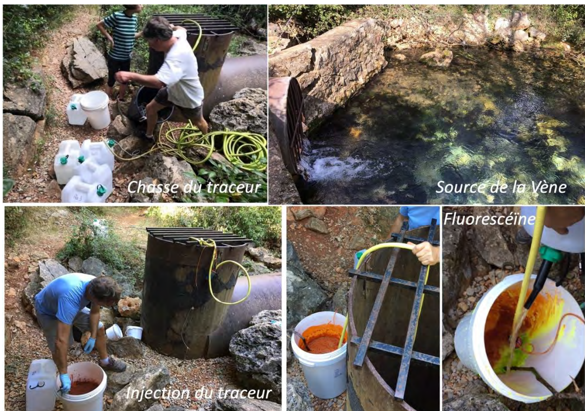
Figure 9 : Opération d'injection du traceur « Fluorescéïne » à la source de la Vène, selon un protocole reproduit à l'identique lors des différents essais de traçages du projet.
